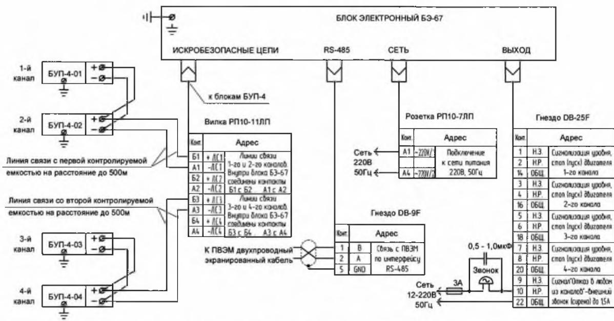
Примечание. На схеме приведен пример подключения блоков БУП-4 для контроля верхнего и нижнего уровней в двух емкостях. Остальные варианты соединений приведены на рис. 5
