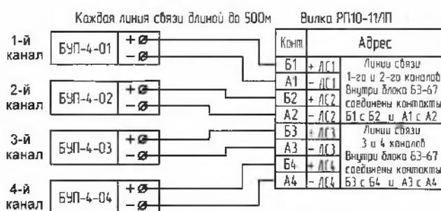
Контроль четырех емкостей на каждой емкости по одному контролируемому уровню
