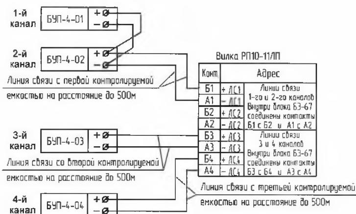
Контроль трех емкостей, на одной из которых два контролируемых уровня, на остальных - по одному.
