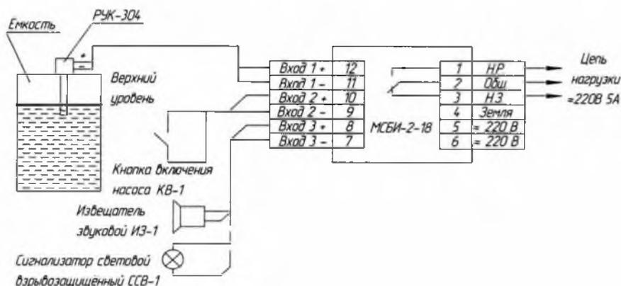
Состав системы: реле уровня РУК-304; модуль сигнально-блокировочный МСБИ-2-18-3; извещатель звуковой взрывозащищенный ИЗ-1 или сигнализатор световой взрывозащищенный ССВ-1; кнопка взрывозащищенная КВ-1 для включения насоса.
