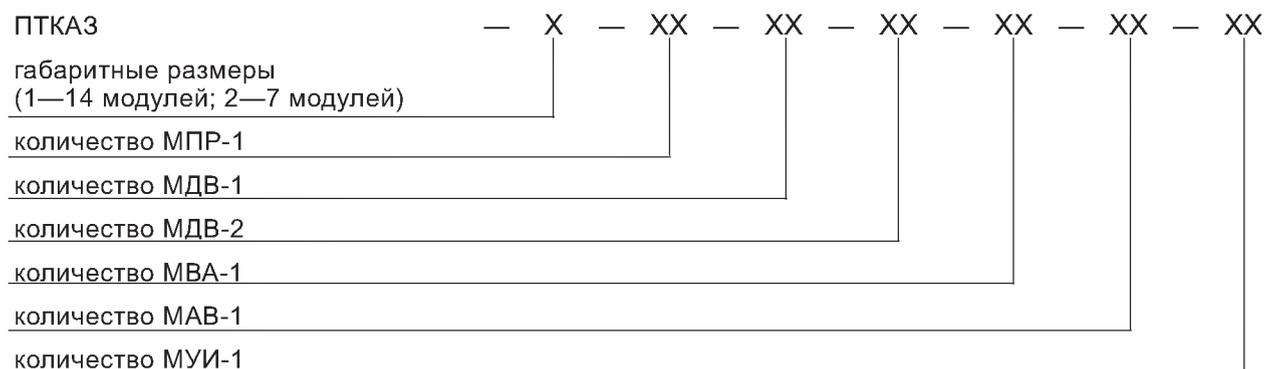
Пример записи обозначения ПТКАЗ, габаритных размеров 483×133×322 мм. состоящего из трех модулей МПР-1, пяти модулей МДВ-1, одного модуля МДВ-2, одного модуля МВА-1, одного модуля МАВ-1, одного модуля МУИ-1 при заказе и в документации другой продукции:
