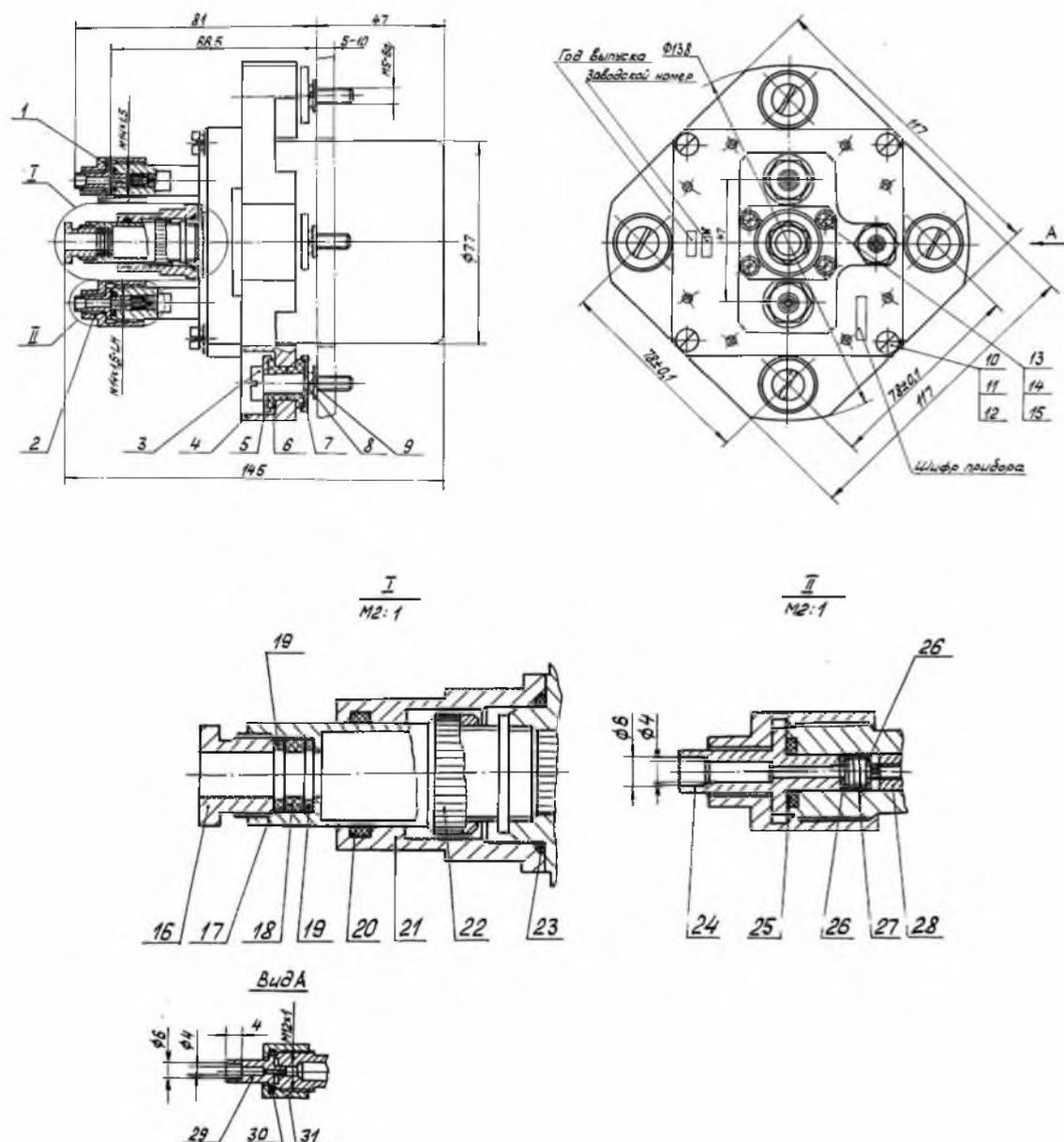
1, 2 — накидная гайка; 3 — винт; 4 — плата; 5, 7 — шайба; 6 — втулка; 8 — шайба; 9 — шайба; 10 — винт; 11 — шайба; 12 — шайба; 13 — винт; 14 — шайба; 15, шайба; 16 — штуцер; 17 — кожух; 18 — втулка; 19 — шайба; 20 — кольцо; 21 — стакан; 22 — розетка; 23 — кольцо; 24, 29 — ниппель; 25 — кольцо; 26 — шайба; 27 — пружина; 28 — огнепреградитель; 30 — прокладка; 31 — накидная гайка.
