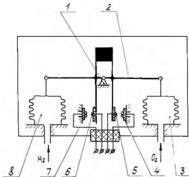
1 — опора рычага; 2 — рычаг;
